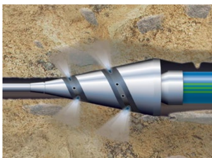
Black-Box-Verlegung wie Spülbohrung, Berstlining, Relining
