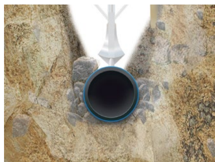
offene Verlegung ohne Sandbett, Pflug-/ Fräsverfahren
