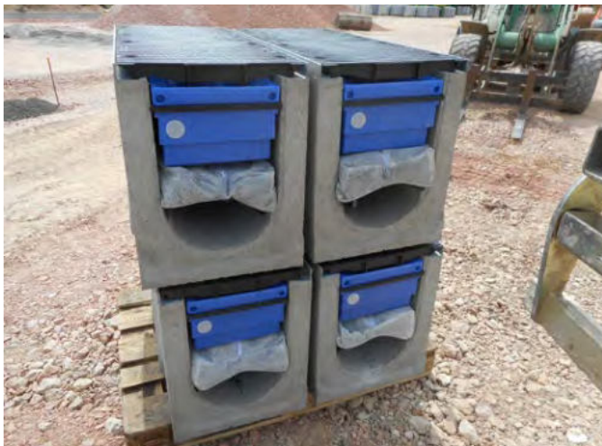
Elemente der Regenwasserbehandlungsanlage BIRCOpur® readysset, d. h. verlegefertig vormontierte Bauelemente mit Abdeckung, Sedimentationsfilter (blau) und Reinigungskissen. Betonschale in wasserdichter Ausführung. Foto: Müller + Huber
