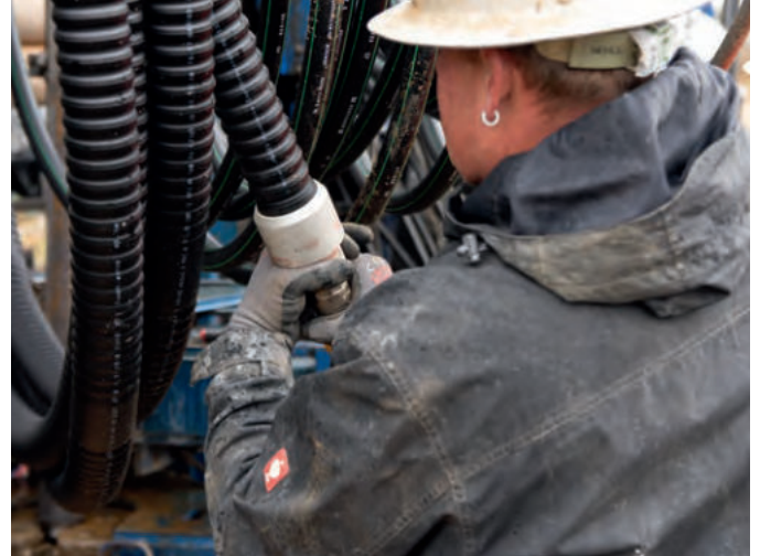
Kupplung für einfaches Befüllen und Absperren der Sonde
