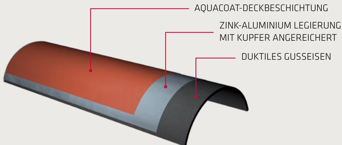
Das Umhüllungssystem BioZinalium ist für den Einsatz in den meisten Böden geeignet. Ausnahmen sind säurehaltige torfige Böden und mit z.B. Schlacke oder Asche kontaminierte Böden, sowie Böden unterhalb des Meeresspiegels mit einem Bodenwiderstandswert von weniger als 500  $\Omega \cdot m$
