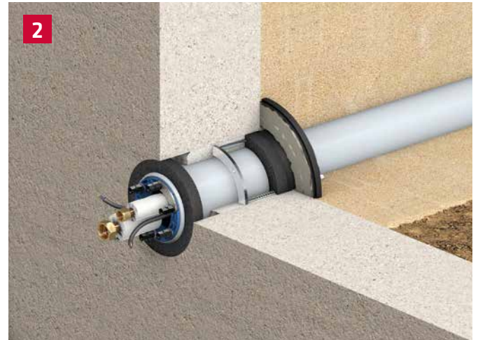
Quadro-Sicura® Quick/H in Kombination mit Curaflex Nova® Uno/M/Z
