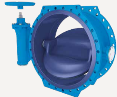
DN 150 - 1200 PN 10 - 16 GEHÄUSE: EN-JS 1030 BESCHICHTUNG: AUßEN: EKB INNEN: EMAIL KLAPPENSCHLEIBE: EMAIL
