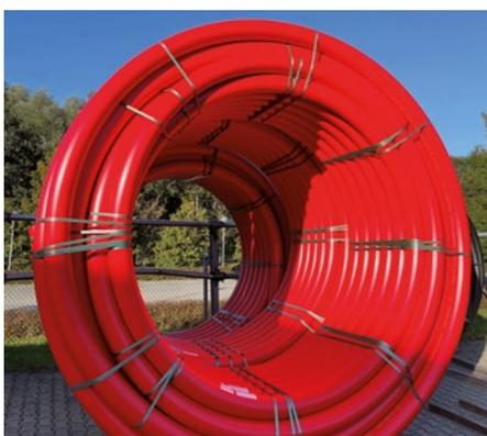
Höchstspannungskabel benötigen Schutzrohrsysteme mit dauerhafter Wärmestabilisierung sowie sicherer stoffschlüssiger Verbindungstechnik. Das neue LHT® Rohr besitzt diese notwendigen Eigenschaften und ist vor allem für eine Dauertemperatur von >70 °C, wie sie bei voller Netzlast auftreten kann, ausgelegt. Der Verbau erfolgt dabei analog den Vorgaben konventioneller PE 100 Druckrohrleitungen, z. B. max. mögliche Einzugskräfte.
