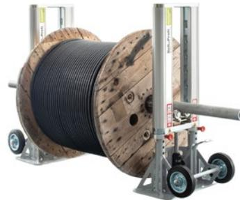
Der MINILIFT rollt schwere und große Kabeltrommeln bis zu einem Gewicht von 4 Tonnen problemlos und einfach ab.
