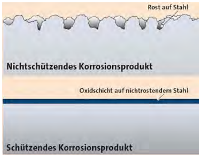
Beispiele von Korrosionsprodukten
