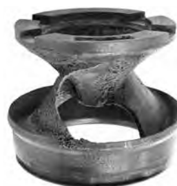
Darstellung eines beschädigten Laufrads durch Kavitationseinwirkung
