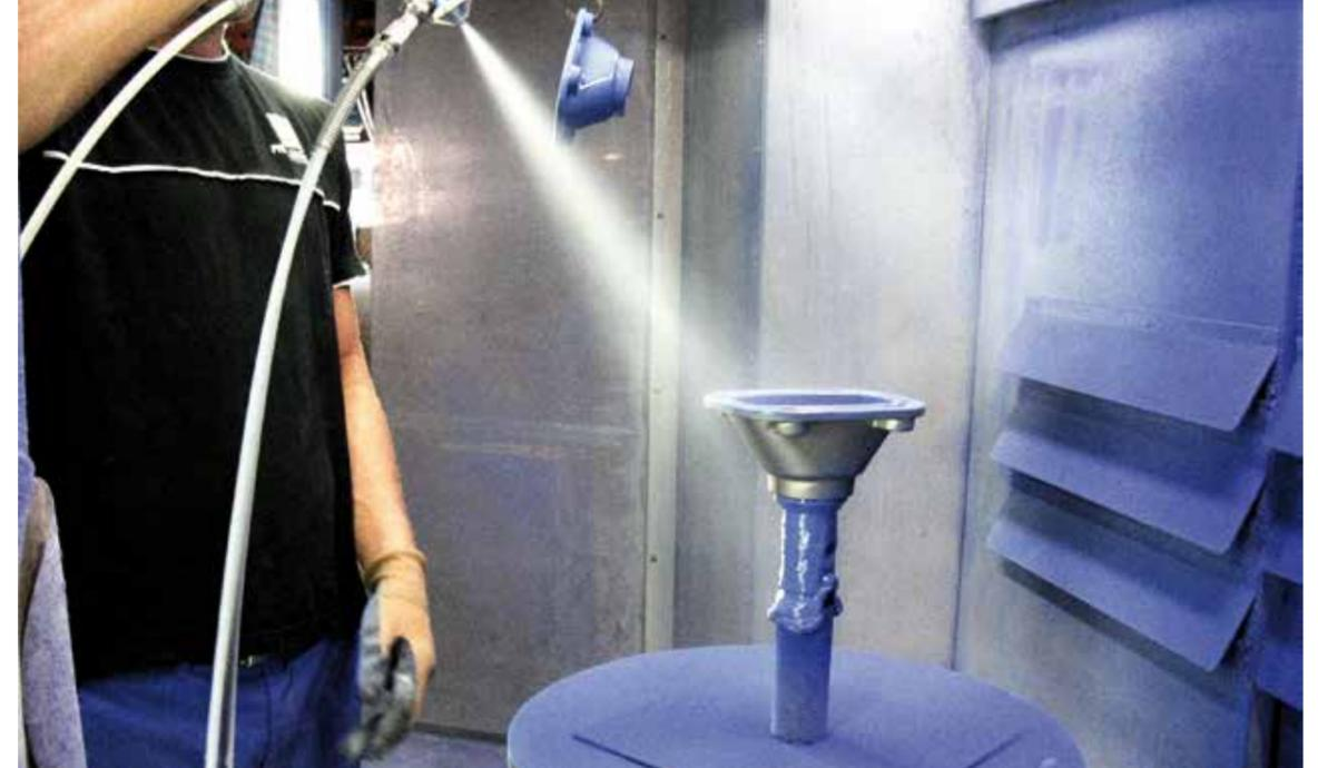
Emaillschlicker wird bei Düker durch Spritzen oder Fluten aufgebracht
