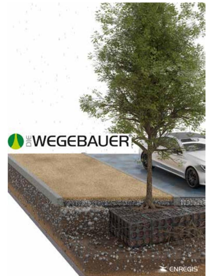
Aufbau einer Wassergebundene Wegedecke mit Sabalith® und Sabadyn® in Kombination mit dem ENREGIS/Treebox® System und Herbavital® Pflanzsubstrat im Schnitt.
