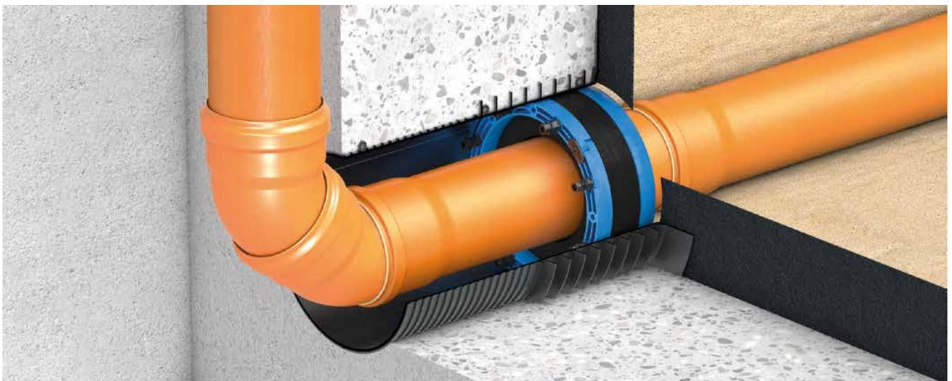
Systematische Darstellung: Einbau Curaflex Nova® KFR in Kombination mit Curaflex Nova® Uno
