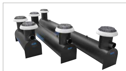
ENREGIS/Vivo Pipe® Im Dauerüberstau betriebene Hocheffizienz-Strangsedimentationsanlage für Anschlussflächen bis zu 4.500 m²
