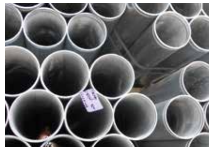
VERZINKTE NAHTLOSE STAHLROHRE EN 10216-1 | P235TR2 | HL 5-7 m | verzinkt EN 10240-A1 bzw. EN 1461 | beidseitig genutet | 60,3-168,3 mm
