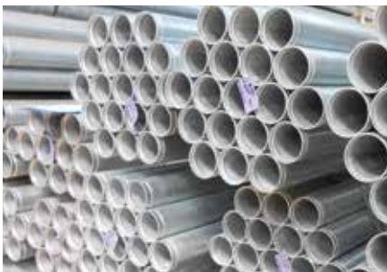
VERZINKTE GESCHWEIßTE STAHLROHRE MIT ERHÖHTER WANDSTÄRKE EN 10217-1 | P235TR1 | HL 6 m | verzinkt EN 10240-A1 bzw. EN 1461 | beidseitig genutet | 114,3-19,1 mm
