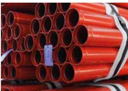
GESCHWEIßTE STAHLROHRE EN 10217-1 | P235TR1 | HL 6 m | beidseitig genutet | pulverbeschichtet RAL 3000 feuerrot | 42,4-273,0 mm
