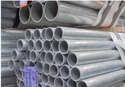
VERZINKTE GESCHWEIßTE STAHLROHRE EN 10255M | S195T | HL 6 m | verzinkt EN 10240-A1 | glatte Enden | ½"-4"
