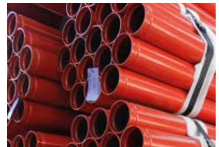
GESCHWEIßTE STAHLROHRE EN 10255M | S195T | HL 6 m | beidseitig genutet | pulverbeschichtet RAL 3000 feuerrot | 1"-2"
