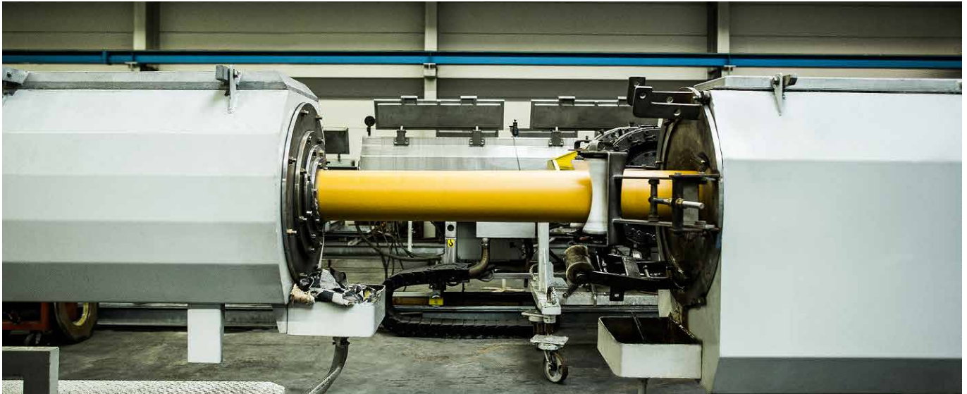
Herstellung eines Rohres aus dem Werkstoff Polyamid 12 für den Transport von Erdgas, Biogas oder Wasserstoff.
