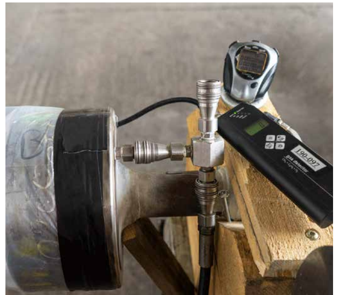
Äußere Dichtheits-Prüfung mit H 2 am Drehschieber
