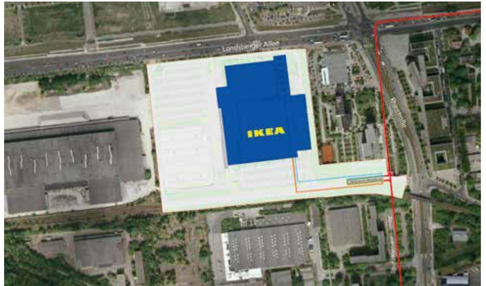
Eine unterirdisch verlegte, 200 Meter lange Abwasserdruckleitung verbindet das Einrichtungshaus mit dem kommunalen Abwasernetz. (Quelle: IKEA/bwp)
