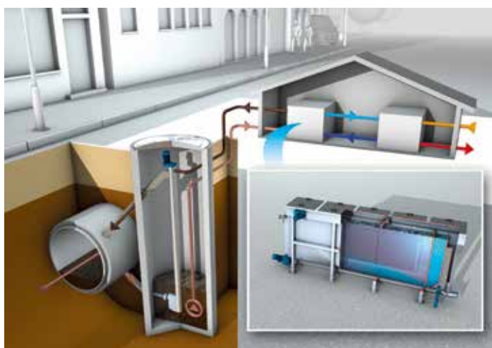
Beispiel für eine Anlage zur Entnahme von Energie aus Abwasser mit Sammlern: das HUBER ThermWin®-System. (Quelle: HUBER SE)
