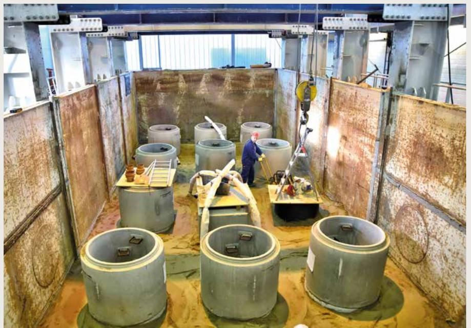
Einbau der Schächte: Für die Systemprüfungen wurden im IKT-Großversuchsstand insgesamt 13 Schächte aus Betonfertigteilen der Nennweite DN 1000 eingebaut. Das Sanierungsziel lautete, die Dichtheit und Tragwirkung des Abwasserschachts wiederherzustellen. (Bild: IKT – Institut für Unterirdische Infrastruktur gGmbH)
