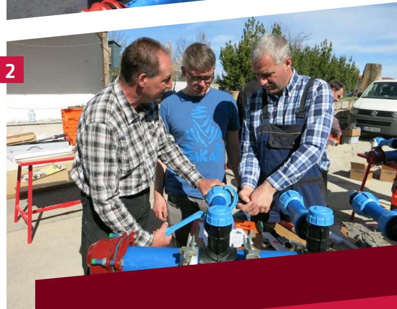
1 +2 | Erstellung des Prüfstücks mit mechanischer Verbindungstechnik mittels Klemmverbindern von Georg Fischer.
