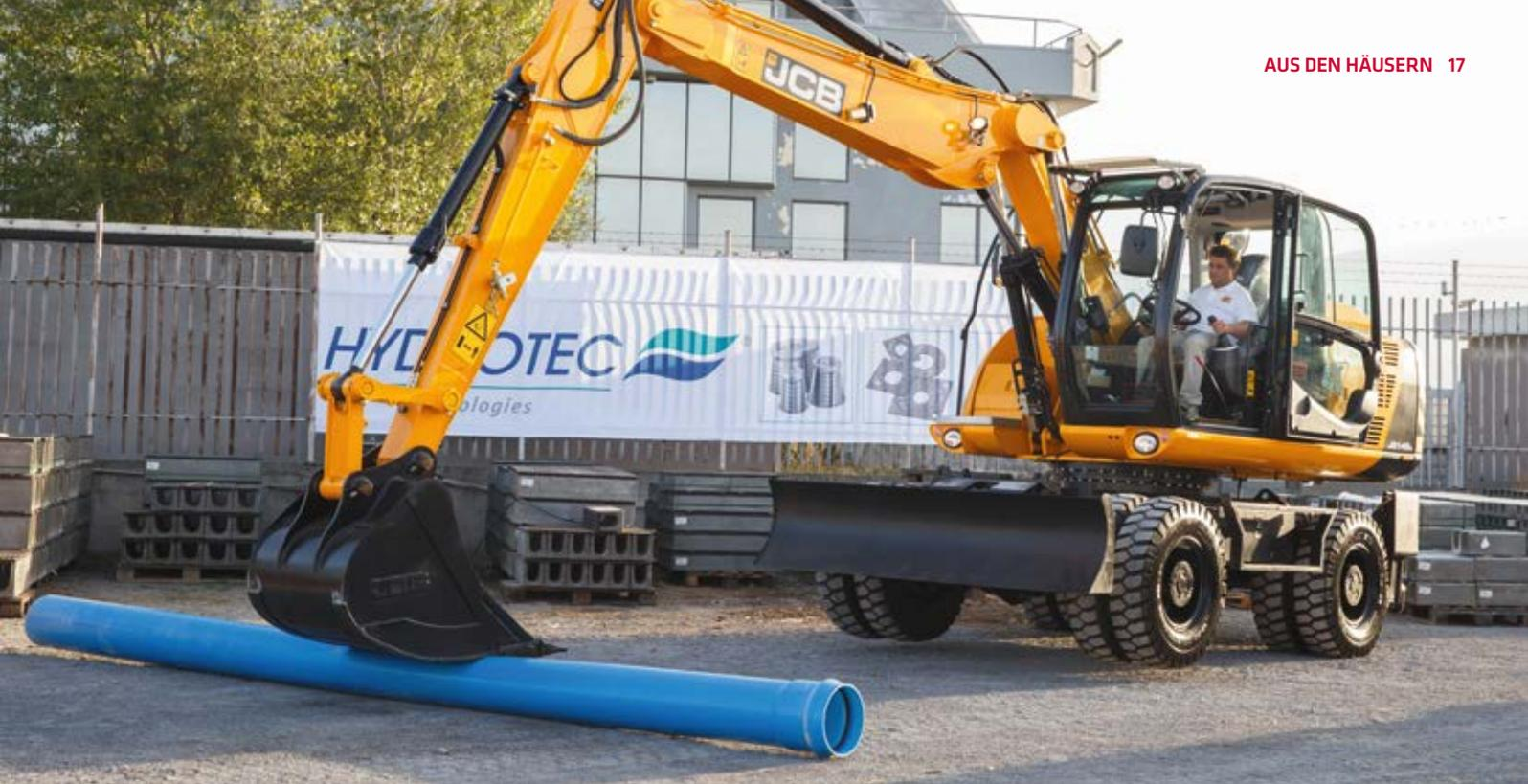
Ein 16 Tonnen-Raupenbagger veranschaulichte die Stabilität des Molecor PVC-O Rohres. (Quelle: HTI BULGARIA)
